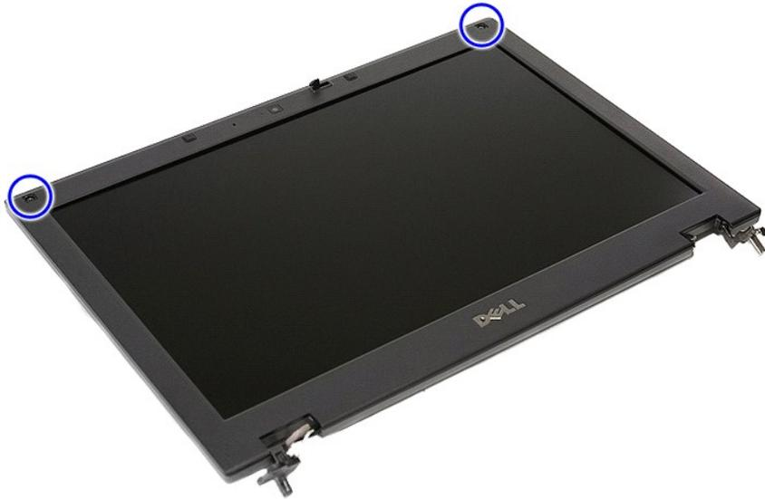
10. Dégagez délicatement le cadre d'écran pour le séparer de l'ensemble écran en faisant passer les doigts sous un bord du cadre et en progressant autour de ce cadre pour le dégager complètement.
