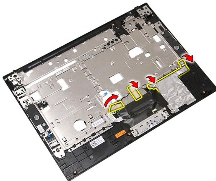
14. Détachez les bandes adhésives fixant le câble de données de la tablette tactile au repose-mains, puis retirez le câble du trou.
