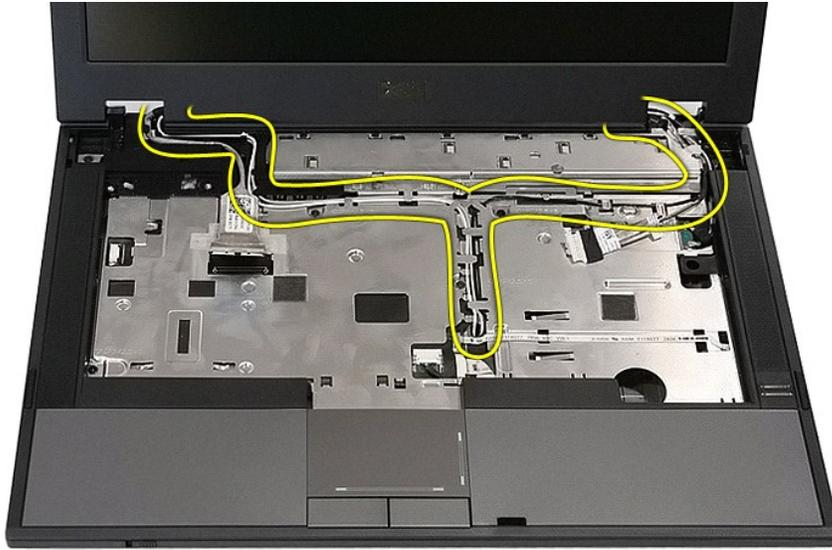
13. Retirez les vis qui fixent l'ensemble d'affichage au châssis de l'ordinateur.
