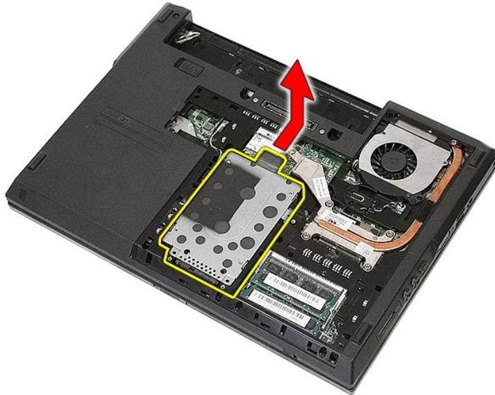
6. Retirez les vis fixant le boîtier du disque dur au disque dur.
