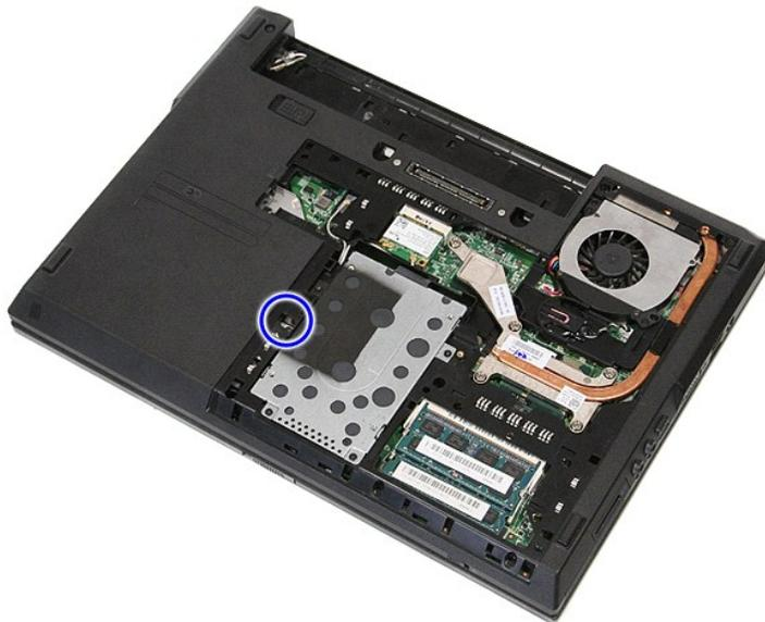
4. Insérez un tournevis en plastique dans l'emplacement de la vis de retenue, puis dégagez et retirez soigneusement le lecteur optique de l'ordinateur.
